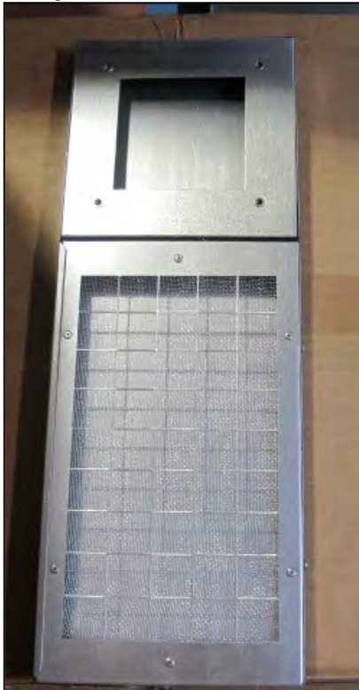
Vista general del filtro no montado en la caldera
