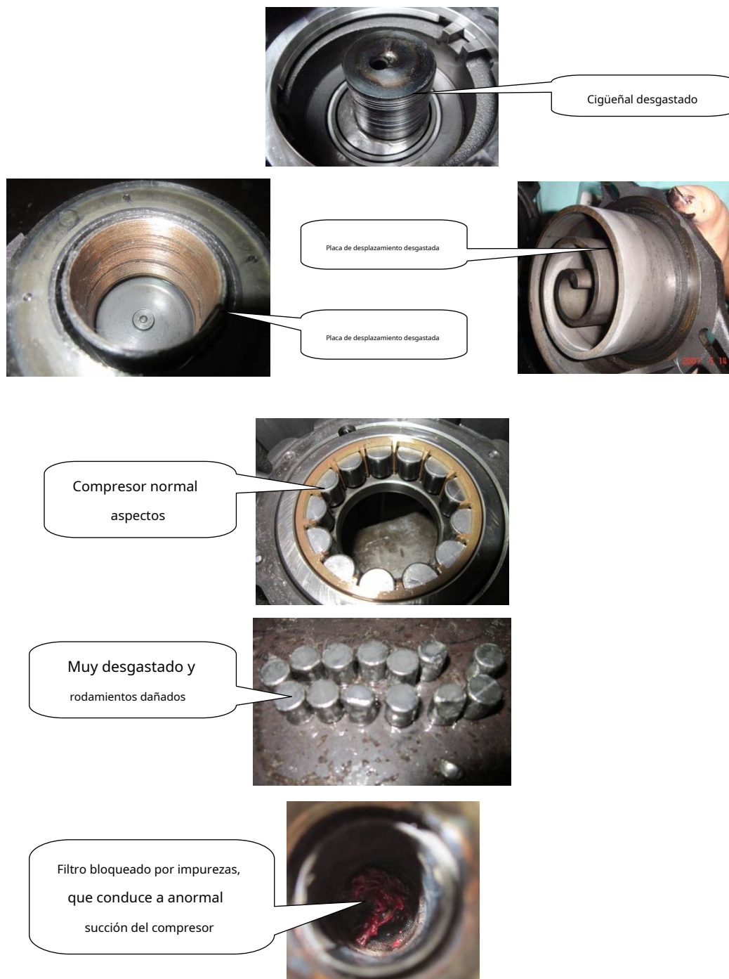
Figura 6-2.11: Efectos del aceite del compresor en mal estado
