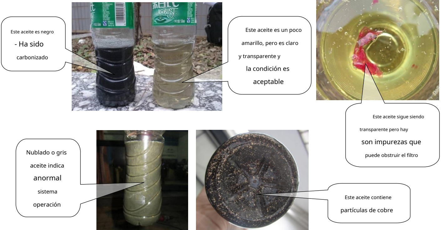
Figura 6-2.10: Inspección del aceite del compresor
