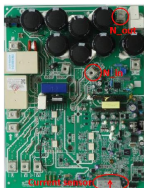
Figura 6-2.5: Método de conexión del cable de detección de CC
