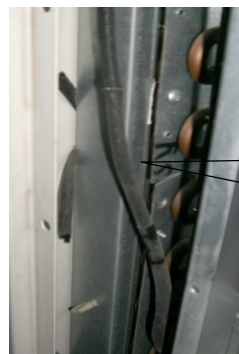
El sensor T4 se ha desgastado y ha entrado en contacto con la chapa metálica
