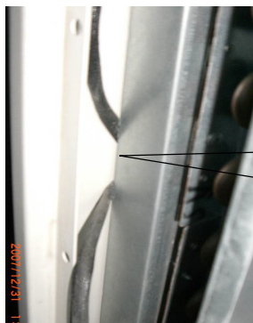
El sensor T4 se ha desgastado y ha entrado en contacto con la chapa metálica
